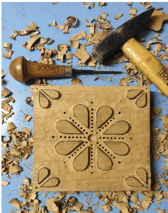
Obr. 34 Výroba novej matrice podľa starého originálu (foto Adam Benko)
