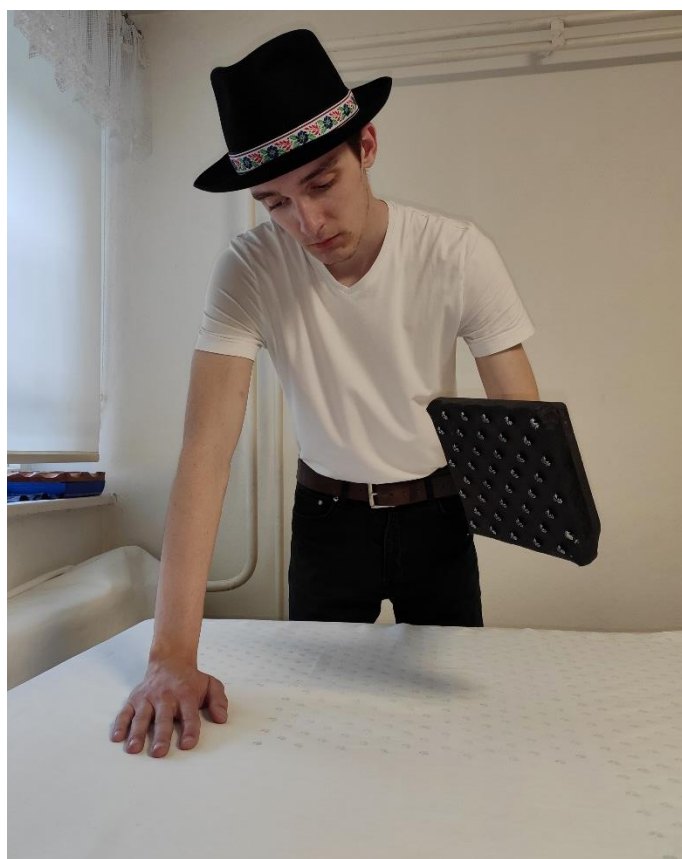
Obr. 36 Výroba metráže – nanášanie papu na látku v dielni (foto Adam Benko)
